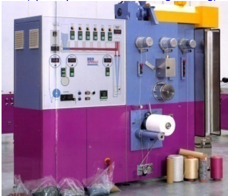
Pilote de filage par voie fondue (Spinboy I of Busschaert Engineering)
