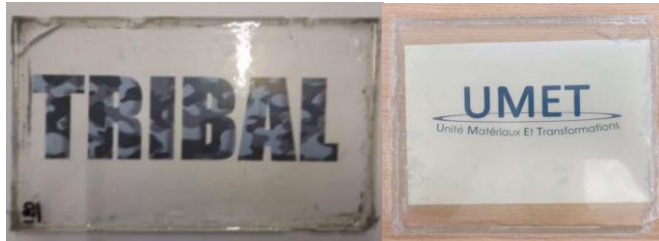
Photo d'une plaque composite transparente, à gauche du projet TRIBAL (ANR ASTRID) 2021-2024, à droite projet COMPTRANS (Région) 2023-2024
